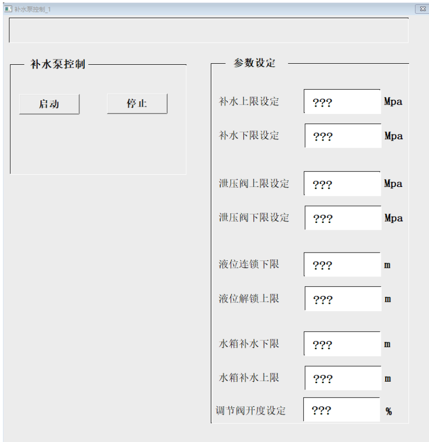
图 2-3-5 补水泵操作画面
